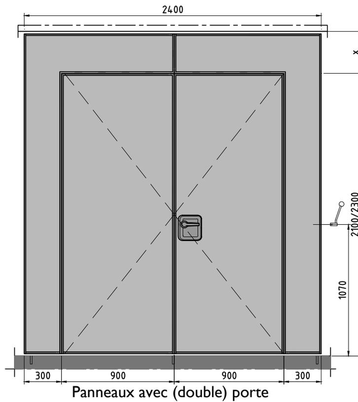
Manuel,  $x = \text{min } 340\text{mm}$  / Semi-automatique,  $x = \text{min } 410\text{mm}$
